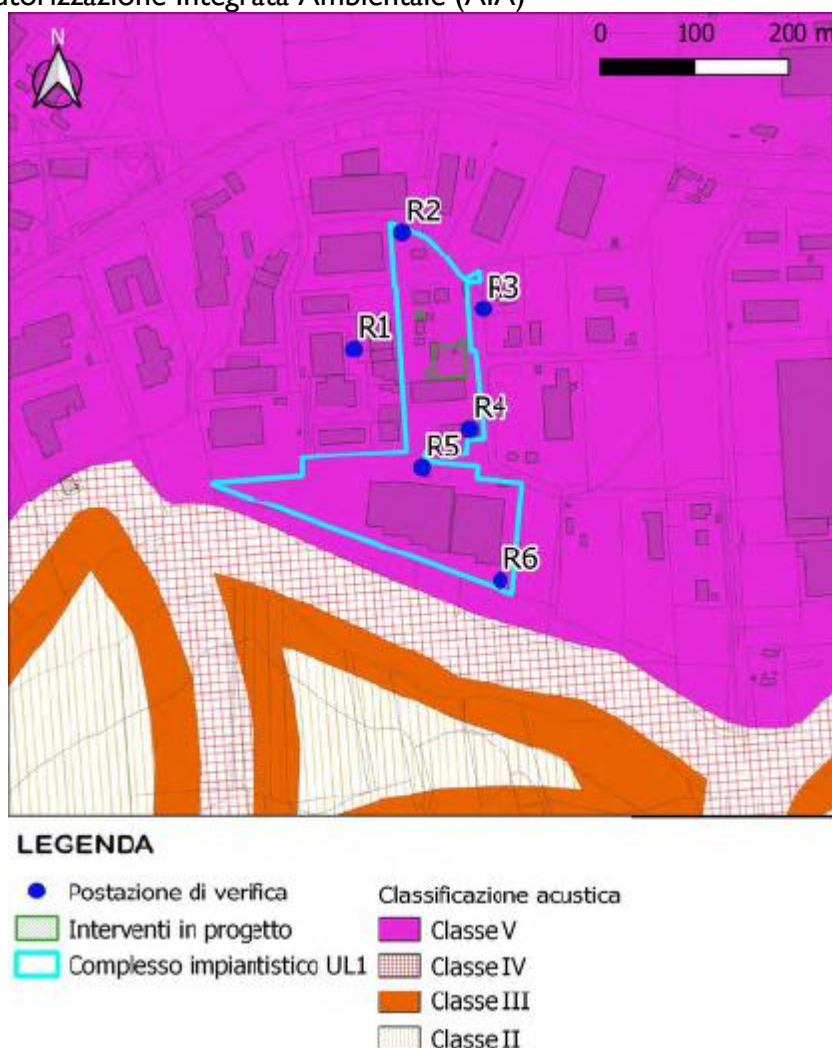
Figura 17 – Ubicazione dei punti di monitoraggio
