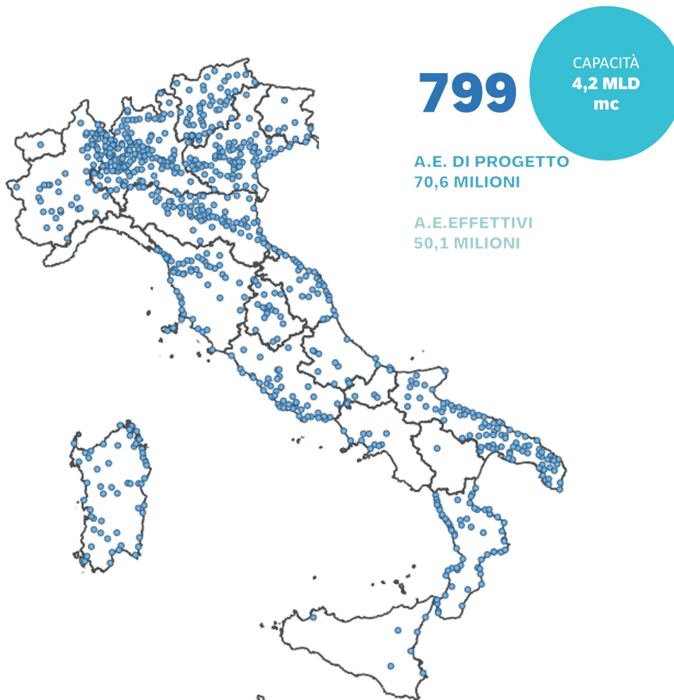
Fig. 3.3 - Distribuzione degli impianti di trattamento delle acque reflue con capacità di trattamento effettiva maggiore di 10.000 a.e. e con livello di trattamento superiore al secondario
